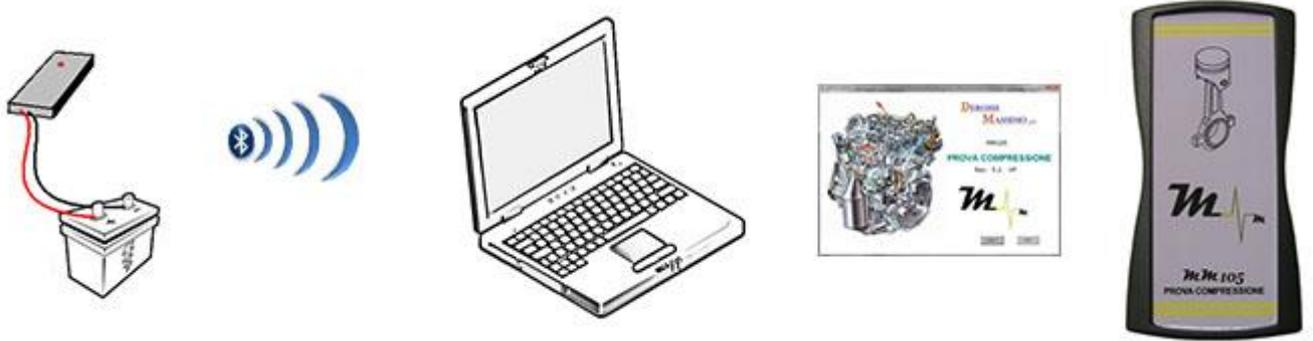
In una prima fase viene calcolata con precisione la velocità di rotazione del motore (RPM=giri/minuto)
