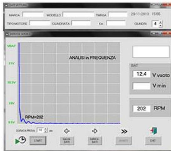
Viene quindi analizzato l'andamento della tensione della batteria durante ogni singolo giro
